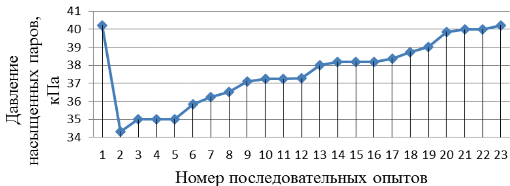
Рисунок 7 – Зависимость давления насыщенных паров модельной жидкости от номера опыта при добавлении в 1-м опыте 8 мг/кг присадки
