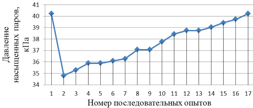
Рисунок 5 – Зависимость давления насыщенных паров модельной среды от номера опыта
