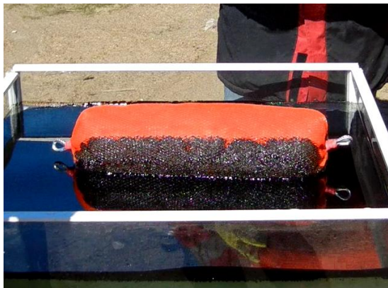
Рисунок 12 - Испытываемый бон размещен в емкости с водой и нефтью
