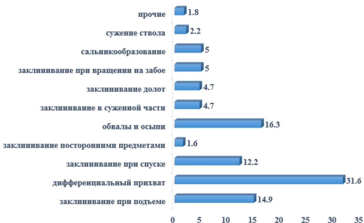
Рисунок 1 – Распределение причин прихватов бурильного и породоразрушающего инструмента (%)
