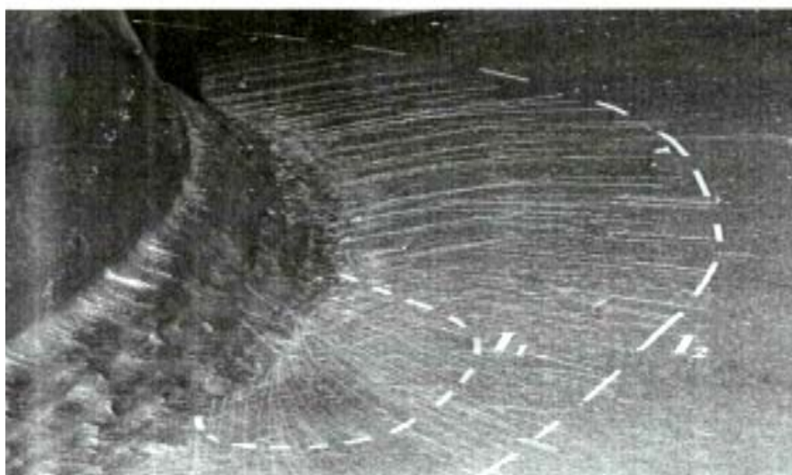
Рисунок 3 - Зоны распространения трещин в хрупком покрытии
