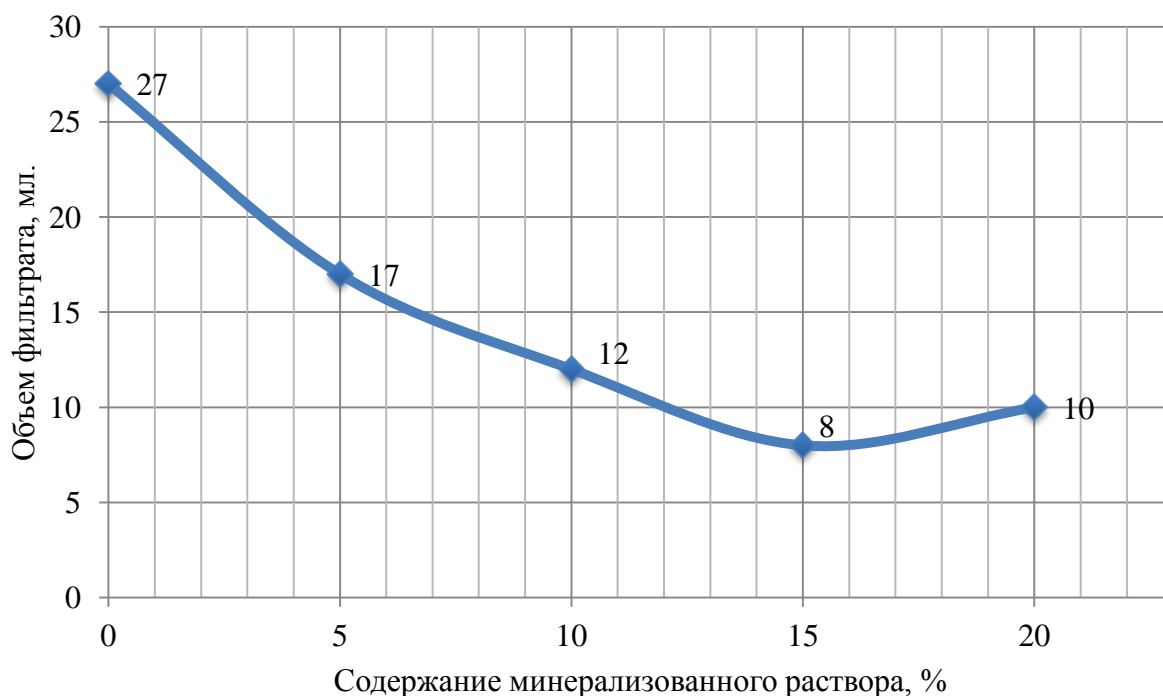
Рисунок 8 - Зависимость объема фильтрата ИЭР от добавки раствора \text{CaCl}_2
