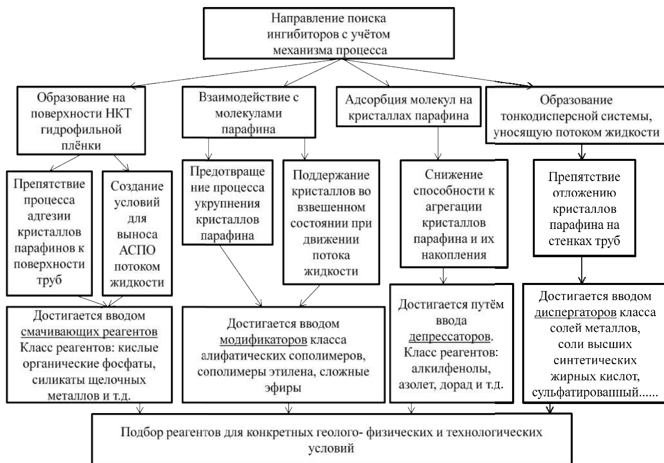
Рисунок 1 - Алгоритм принятия решения по подбору реагентов, предотвращающих образование АСПО на поверхности нефтепромыслового оборудования
